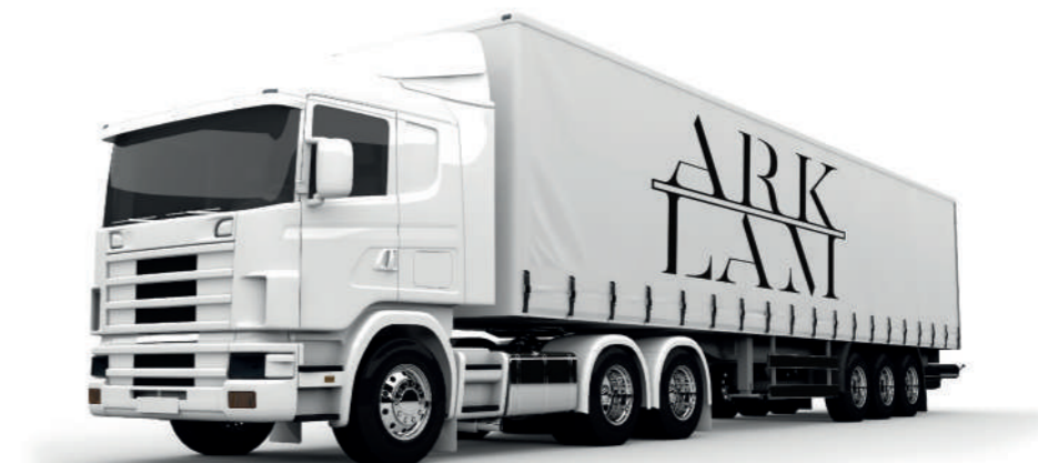
TRAILER SIZE" | MEDIDA CAMIÓN DE LONA 255 cm (Width/Ancho) x 1360 cm (Length/Largo) x 285 (Height/Alto)
