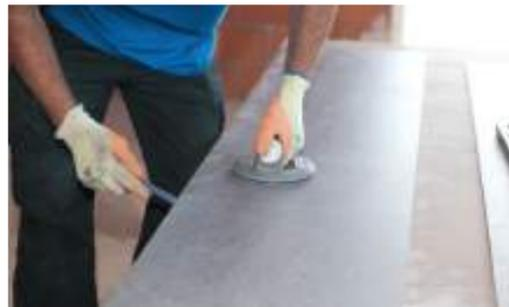
Für kleine Teile oder kurze Längen, kann man den manuellen Diamantstift nehmen.
