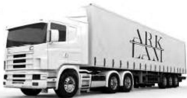
TRAILER SIZE | MEDIDA CAMIÓN DE LONA 255 cm (Width/Ancho) x 1360 (Length/Largo) x 285 (Height/Alto)
